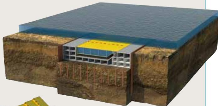
**2** Lorsque la marée monte de plus de 110 centimètres, l'air comprimé est introduit dans les portes pour vider l'eau qu'elles contiennent et qu'elles commencent à se relever.
